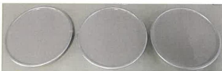
**Bild 5:** Probekörper zur Ermittlung der Shore-Härte
