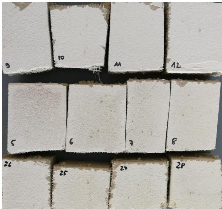
Bild 3: Prüfkörper im Systemaufbau Power Protect eco P40; Reihe oben Kontrollen ohne visuelle Beanstandung, Mitte Verfahren B mit starker Einfärbung durch das Nährmedium Malzextrakt, unten Verfahren A mit nur geringen Verfärbungen.
