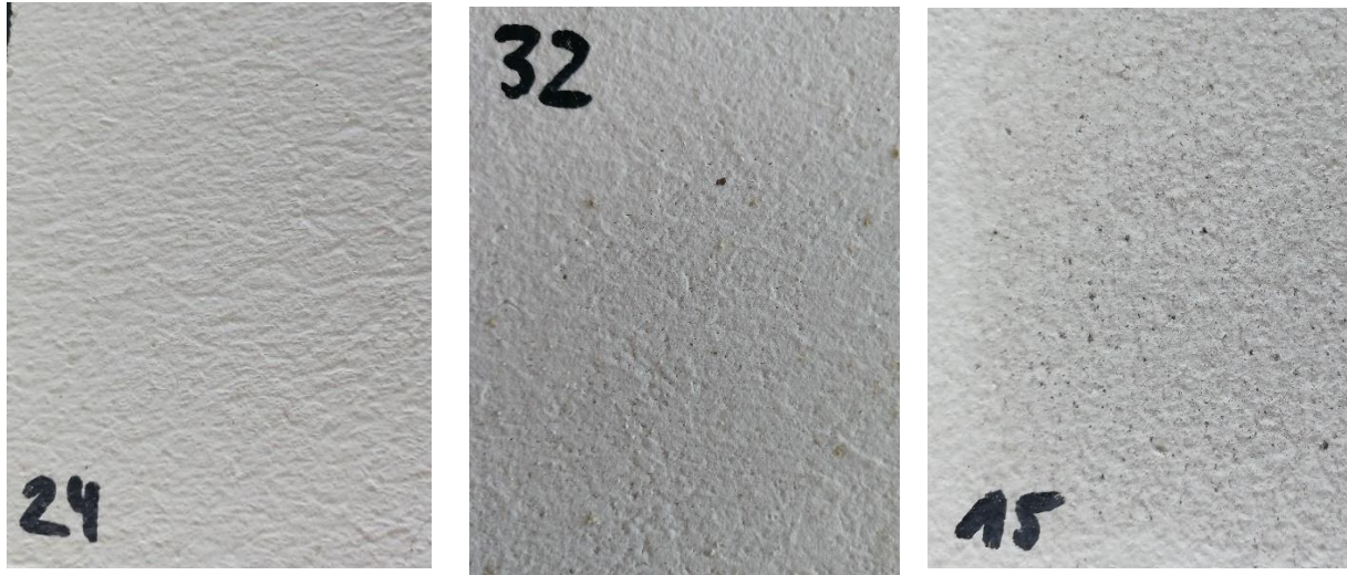
Bild 4: Prüfkörper im Systemaufbau P25 nach Entnahme aus dem Klimaschrank:
