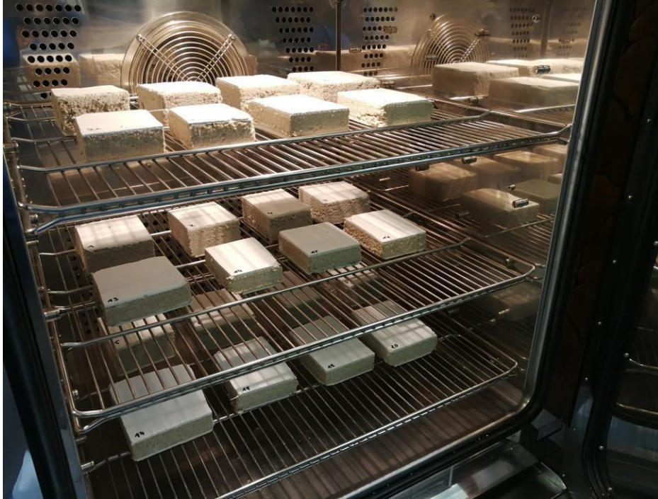
Bild 1: Prüflinge im Systemaufbau nach erfolgter Beimpfung im Klimaschrank
