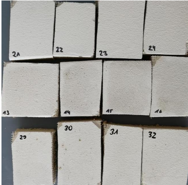
Bild 2: Prüfkörper im Systemaufbau Power Protect eco P25; Reihe oben Kontrollen ohne visuelle Beanstandung, Mitte Verfahren B mit starker Einfärbung durch das Nährmedium Malzextrakt, unten Verfahren A mit nur geringen Verfärbungen.
