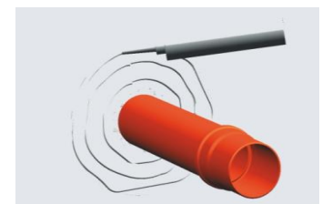
Abb. 4 Aufbringen des Klebers auf die Wand
