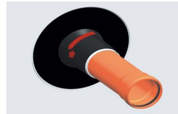
Abb. 6 Rohrflansch fest andrücken
